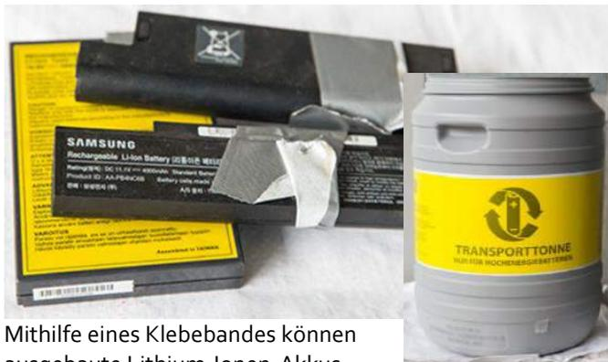
Mithilfe eines Klebebandes können ausgebaute Lithium-Ionen-Akkus leicht gesichert werden
